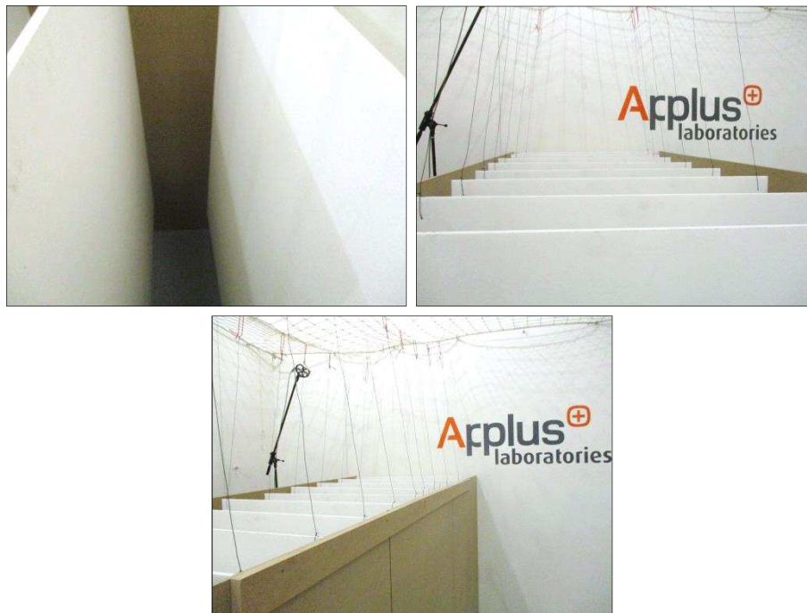
Images 3 à 5 Montage de l'éprouvette dans la salle réverbérante
