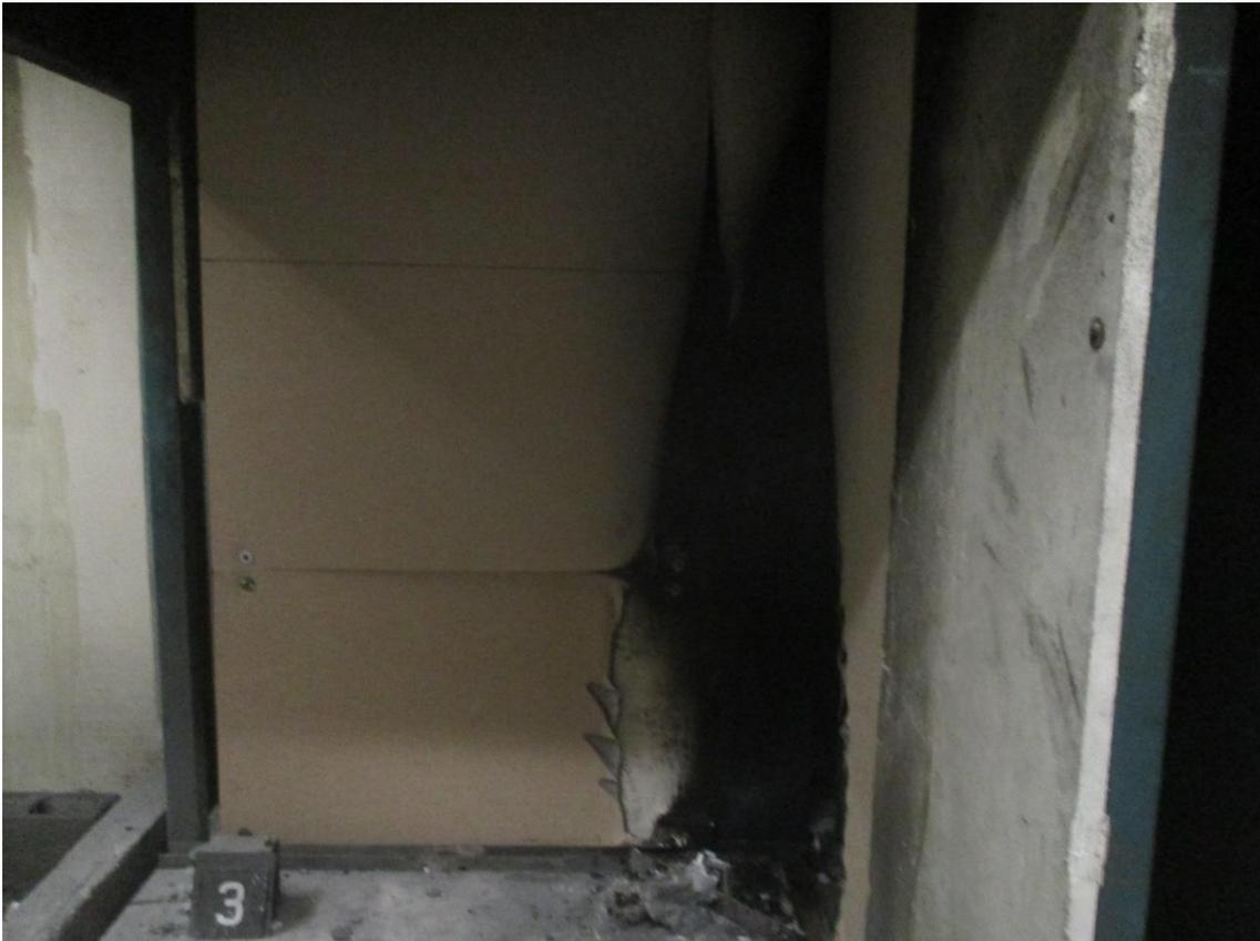
**PHOTO N°10:** Échantillon n°3 - État du produit à la fin de l'essai.
