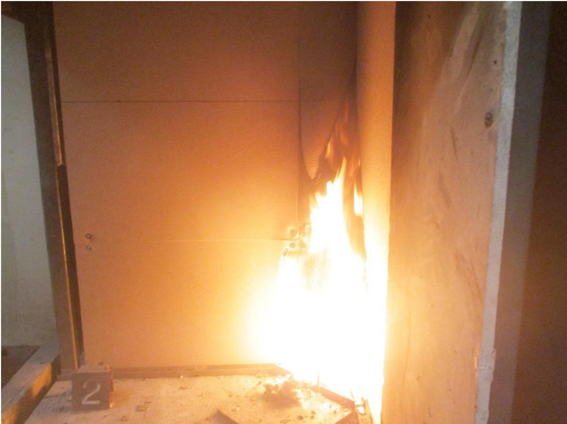
**PHOTO N°7:** Attaque de la flamme après 10 min d'essai environ.
