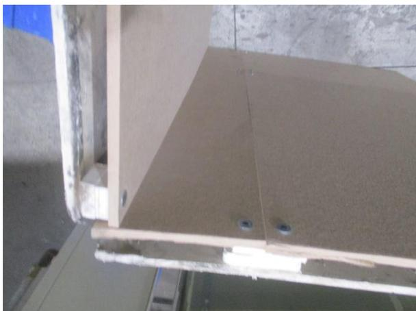
**Photo n°1:** Détail du montage du coin, vue supérieure
