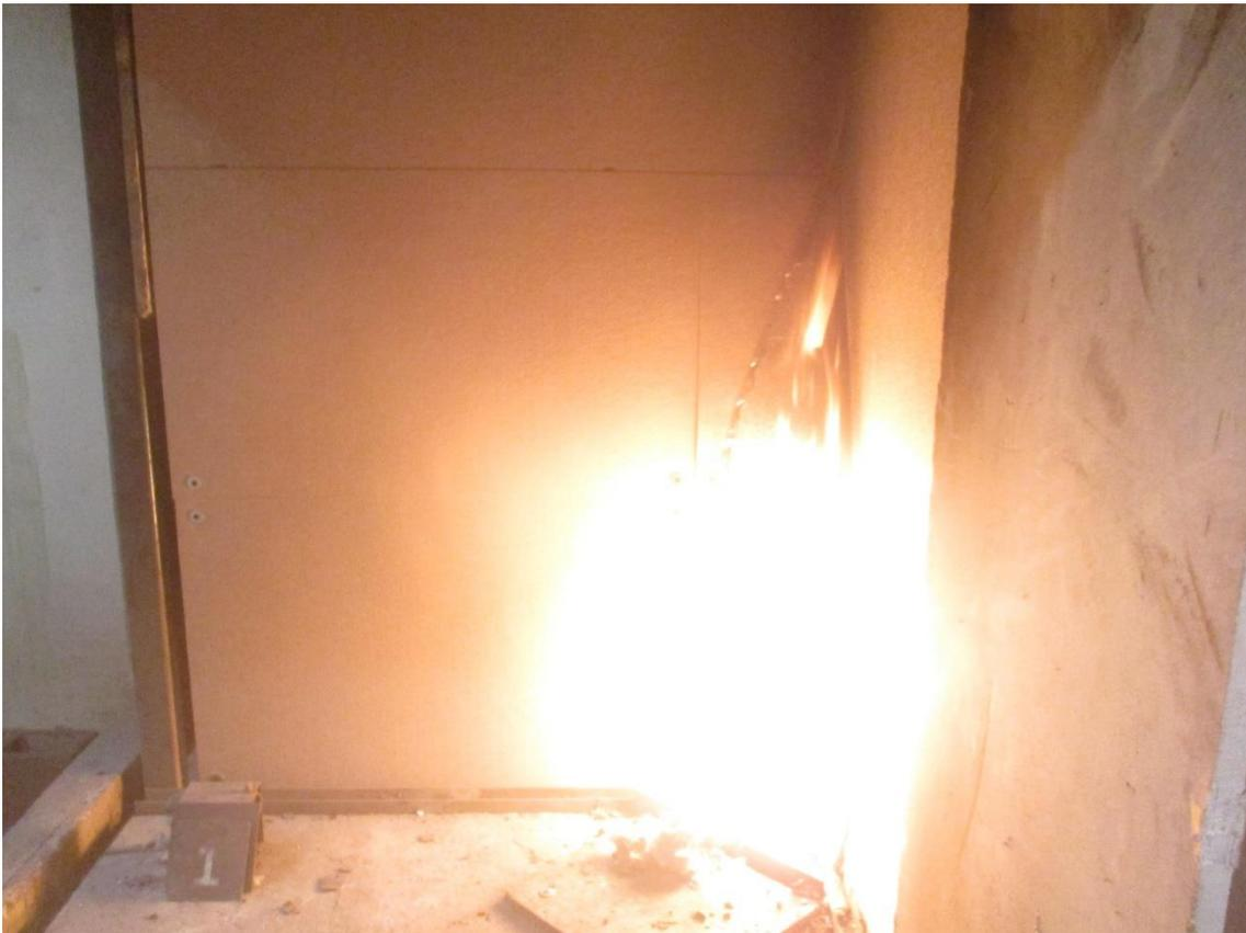
**PHOTO N°5:** Échantillon n°1 - Attaque de la flamme après 10 min d'essai environ.
