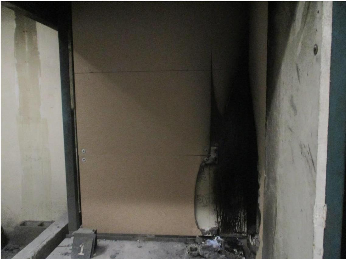
**PHOTO N°6:** Échantillon n°1 - Etat du produit à la fin de l'essai.
